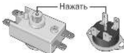
Рисунок 3. Возможные схемы расположения кнопки термовыключателя
